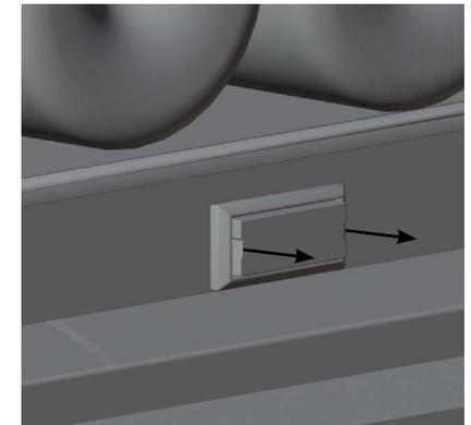
Der Kontaktschalter im Gehäuse kann mit einem kleinen Schraubenzieher ertorgehebelt werden, er ist nicht angeschraubt, sondern nur eingesteckt.
