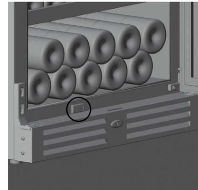
Der Türschalter befindet sich unten über der Sockelleiste
