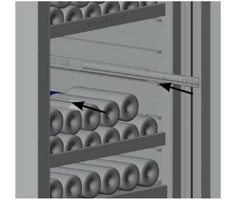
3. Zum wieder einsetzen die Auszugsschienen zurückdrücken, das Tablar beidseitig in die Schienen einfahren und bis an den Anschlag hineinschieben.
