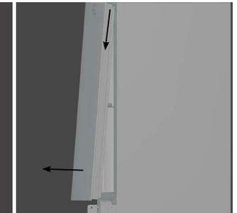
3. Ziehen Sie die Glastüre vorsichtig unten aus dem Scharnier raus und fahren Sie nun mit der Glastüre aus der oberen Führung runter.
