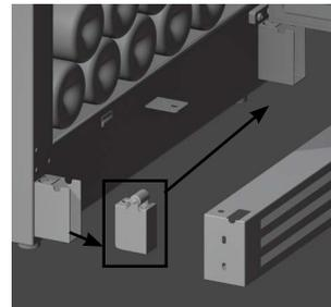
5. Übernehmen Sie jetzt den Führungsrollen einsatz auf die andere Seite (muss am Schluss gegenüber von der Scharnierseite sein) und montieren Sie das Sockelgitter.
