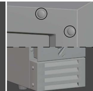
8. Gummiabdeckungen sowie das vordere Lüftungsgitter wieder zurückbauen.
