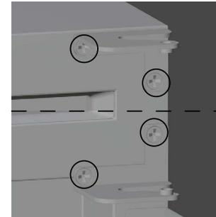
4. Lösen Sie nun die beiden Scharniere oben und unten.
