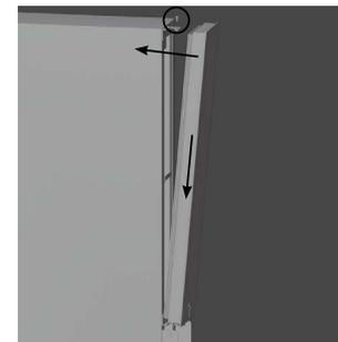
7. Türe nun um 180° drehe und unten wieder in das Scharnier einführen und am oberen Scharnier die Schraube befestigen.
