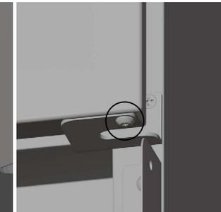
2. Lösen Sie nun die Schraube am Türscharnier damit die Tür herausgezogen werden kann.
