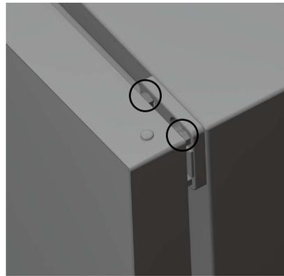
2. Danach die Scharniere mithilfe eines Gabelschlüssels der Größe 8 leicht lösen, die Türe sauber ausrichten und die Schrauben wieder festziehen.
