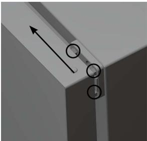
3. Die Scharniere können nun mithilfe eines Gabelschlüssels der Größe 8 gelöst und dann mitsamt der Türe nach links ausgefahren und ausgehängt werden.
